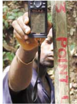
Comprobando la ubicación de una frontera de concesión forestal marcada sobre el terreno
