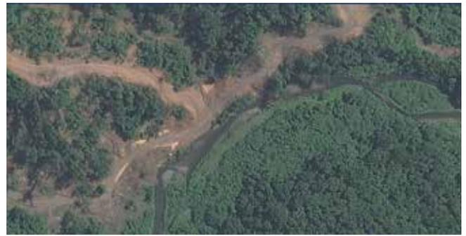
位于首都霍尼亚拉西南方向30公里的瓜达尔卡纳尔岛上的一条伐木道路，它距离一条溪流太近，从而违反了《采伐操作规范》。按照《规范》，小溪两侧25米范围内、沟渠两侧10米范围内不得伐木。溪流被定义为每年有流水超过半年，而沟渠每年有流水不到半年。照片中的道路距离溪流明显不到10米。2018年7月29日。南纬9.61034，东经159.74309
